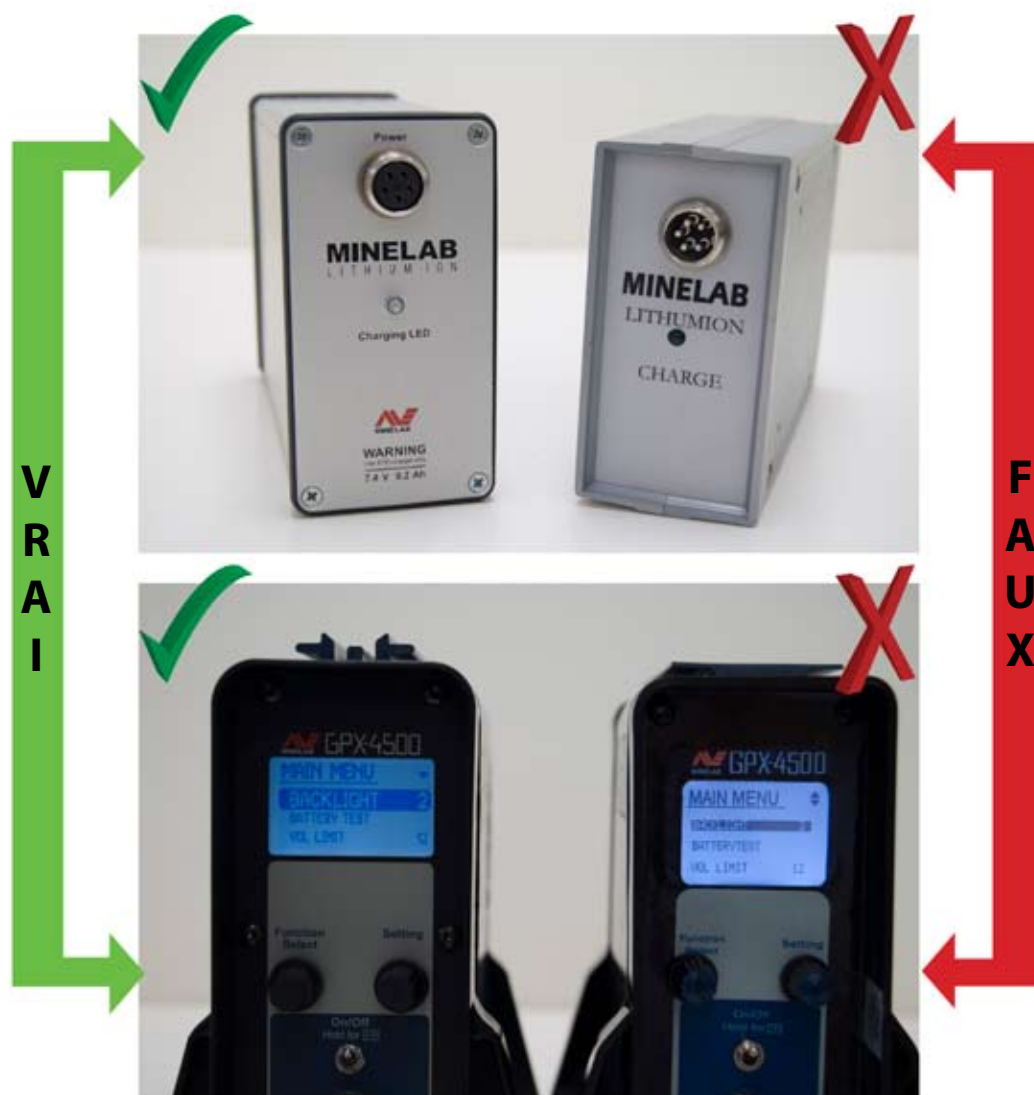
Photo A&B: GPX-4500 réel et contrefait
